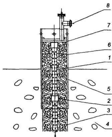
Рис. 3. Схематичное представление обсадной трубы
