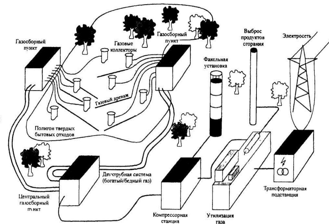
Рис. 2. Устройство системы дегазации полигонах ТБО
