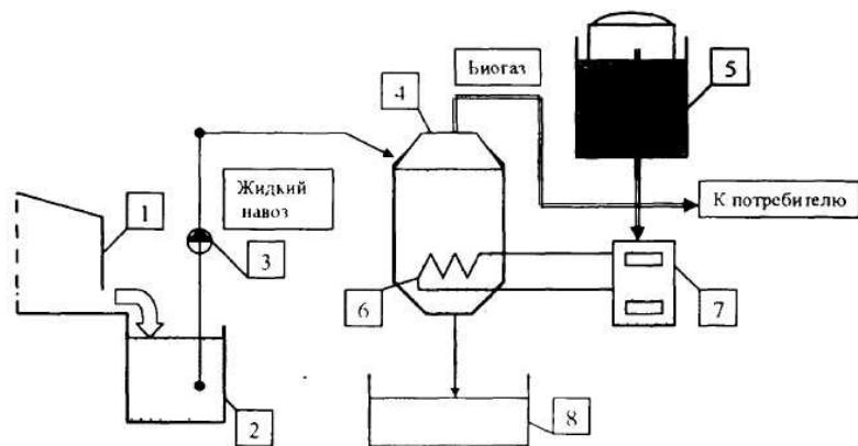
Рис.1. Обобщенная схема производства биогаза
